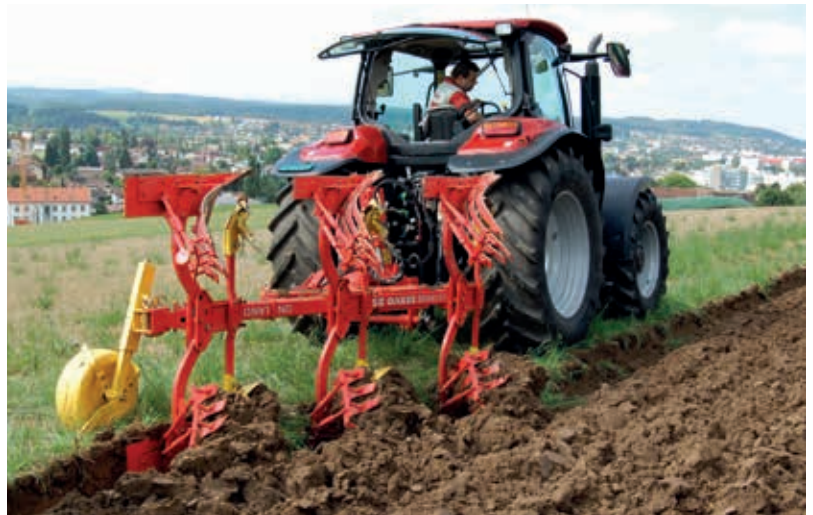
Mit dem Onlandpflug kann außerhalb der Furche gefahren werden. Der noch nicht umgebrochene Boden erleidet weniger Befahrungsschäden. Schlupf und die Bildung einer Pflugsohle können vermieden werden. Aber auch beim Onlandpflug gelten die üblichen Praxisregeln zur Vermeidung von Bodenverdichtungen.
